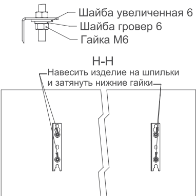
Расположение монтажных кронштейнов для горизонтальной установки на резьбовые шпильки
