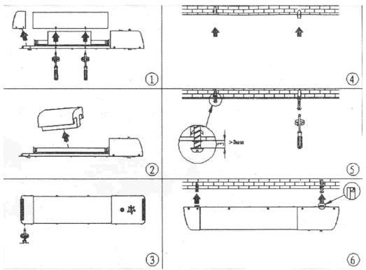
Установка: Отвинтить шурупы и снять пластивовую крышку. Удалить пенопласт. Установить пластиковую крышку назад и закрутить шурупы. Поместить два пластиковых дюбеля в отверстия на монтажной поверхности. Завинтить два шурупа в подготовленные дюбеля, сохраняя расстояние между головкой шурупа и монтажной поверхностью не менее 3 мм. Подвесить арматуру на шурупы.
