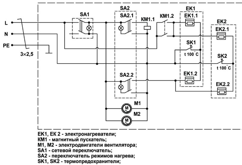
Рис.8 Схема электрическая завесы НТ 508
