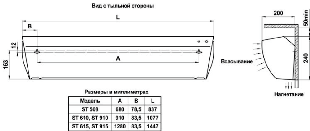
Рис. 2 Габаритные и установочные размеры
