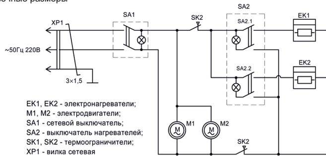
Рис. 3. Схема электрическая
