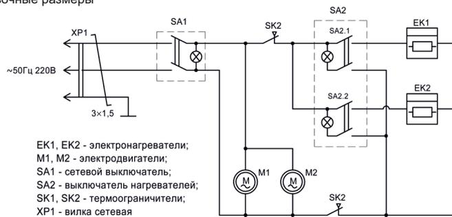
Рис. 3. Схема электрическая
