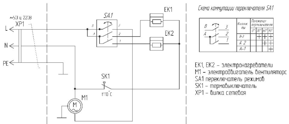
рис. 3 Схема электрическая.
