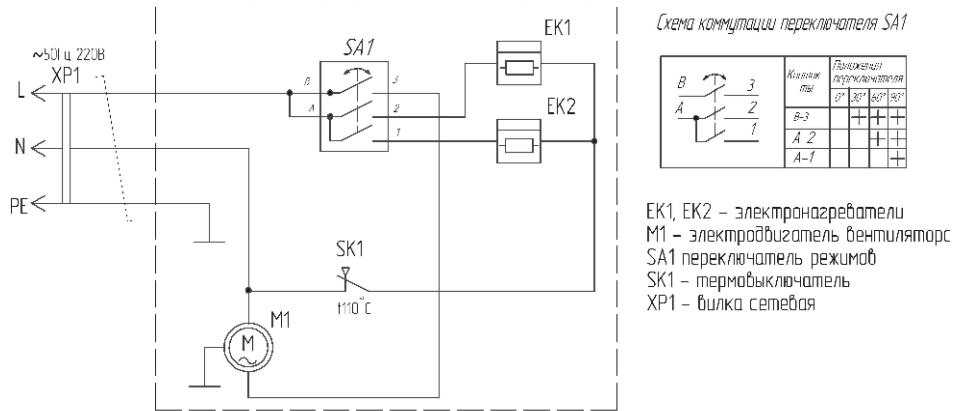
рис. 3 Схема электрическая.
