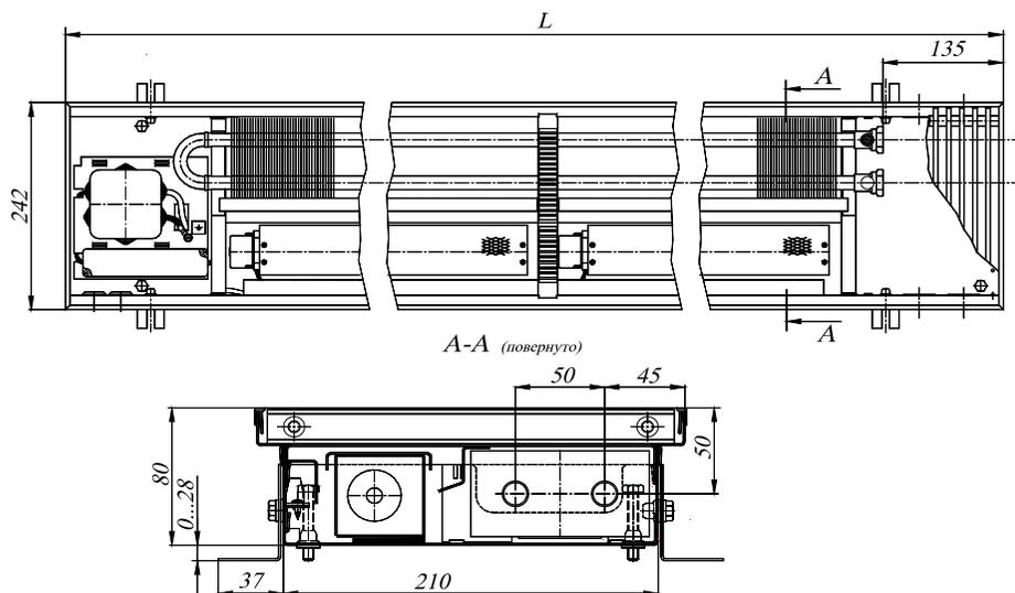
**Рис.2 Конвектор КВК12 24.08.060...310-ВП-П****.Таблица 1**
