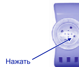
Рис.3. Расположение штока на термовыключателе термостата
